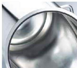
Spaltfreie Abdichtungen im Behälteroberteil gewährleisten eine reproduzierbar gute Reinigung.
